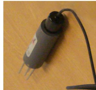
**Abb. 6.5: Bodenfeuchtigkeits-Messgerät für Penetrologger**
