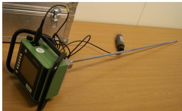
**Abb. 6.2:** Penetrologger mit Bodenfeuchte-Messgerät (IBLB, BOKU Wien, 2011)
