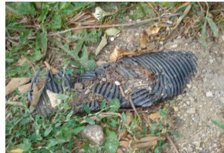
**Abb. 7.94: Zerdrücktes Gießrohr von Baum 60**
