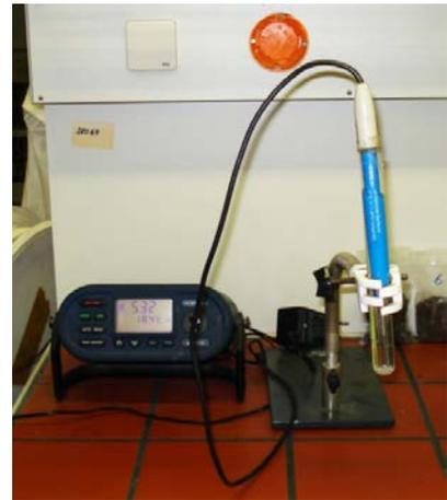
**Abb. 6.6: pH-Messgerät mit Messelektrode**
