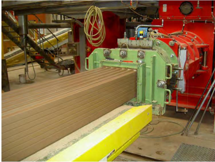
Abbildung 8.3: Strangpresse zur industriellen Ziegelherstellung [158]
