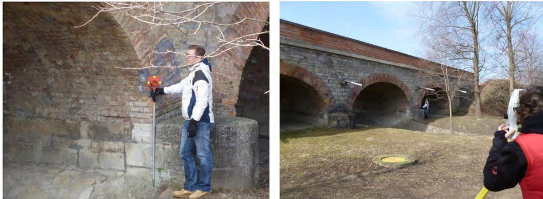
(a) Detaillierte Vermessung der Rohrbachbrücke
