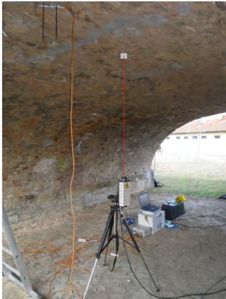
(a) Position des Laservibrometers im Bogen 3
