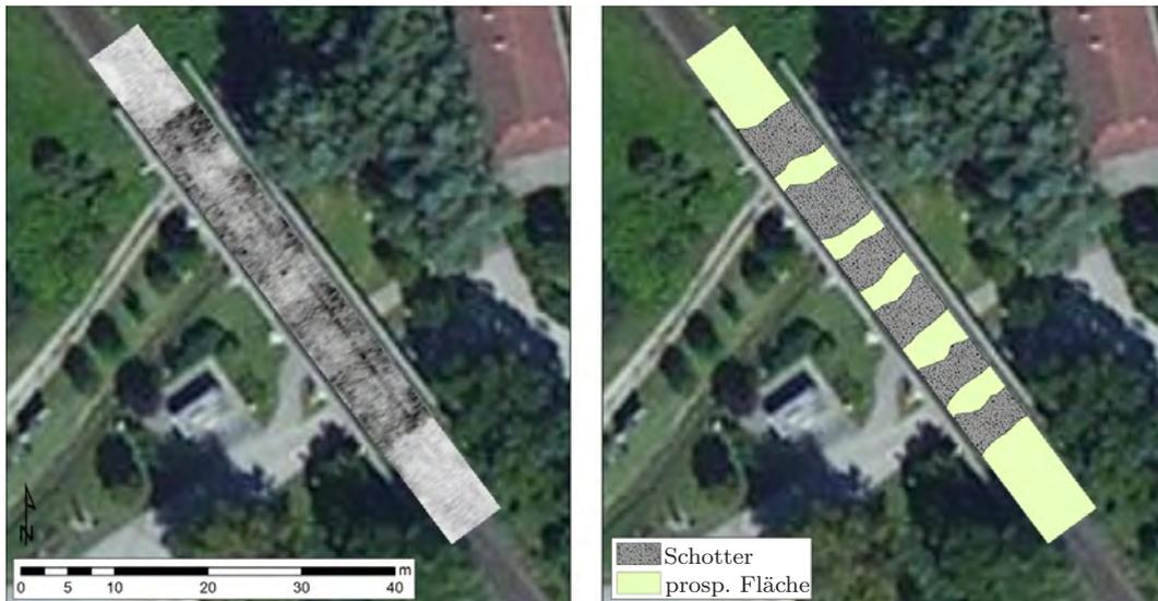
Abbildung 6.20: Darstellung der Draufsicht der Amplitudenfläche (links) und der Interpretation des Tiefenbereiches (rechts) 2.00 bis 2.50 m.
