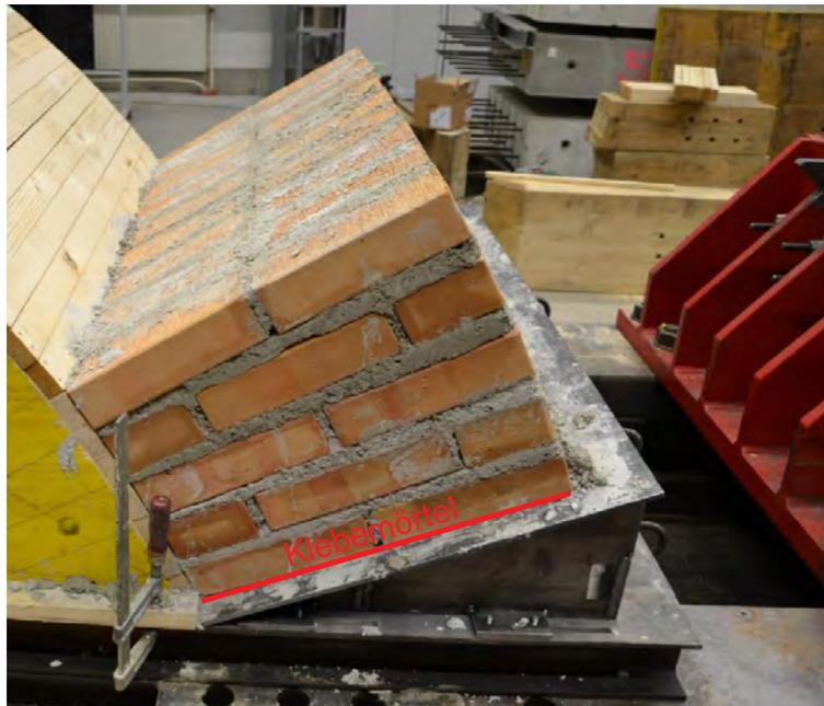
Abbildung 9.8: Befestigung der untersten Ziegelschar mittels Klebemörtels zur Nachbildung der Widerlager
