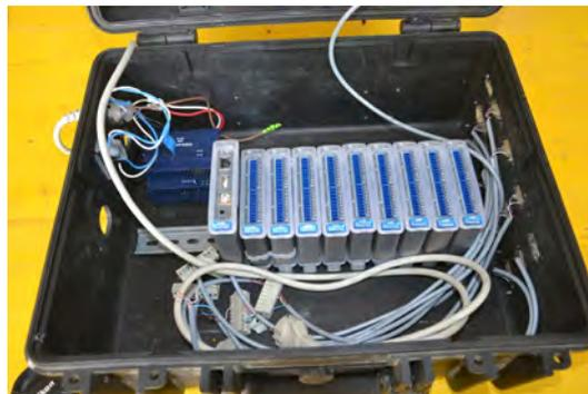
Abbildung 9.22: Darstellung des Messkoffers mit den Messmodulen von GANTNER für die Labormessungen
