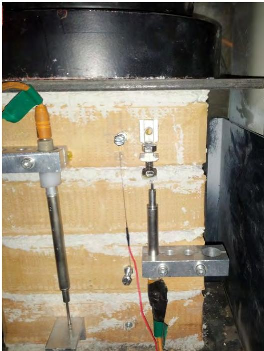
(a) Messanordnung zur Überprüfung der CFK Lamelle
