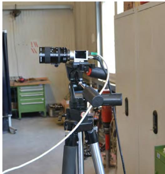
Abbildung 5.5: Darstellung der verwendeten Kamera für die optischen Verformungsmessungen
