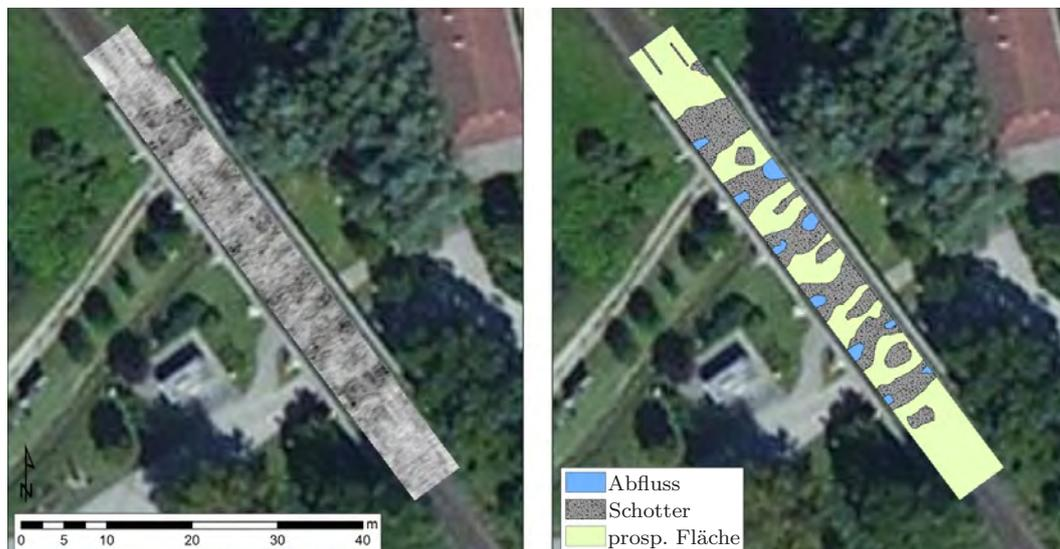
Abbildung 6.18: Darstellung der Draufsicht der Amplitudenfläche (links) und der Interpretation des Tiefenbereiches (rechts) 1.00 bis 1.50 m.
