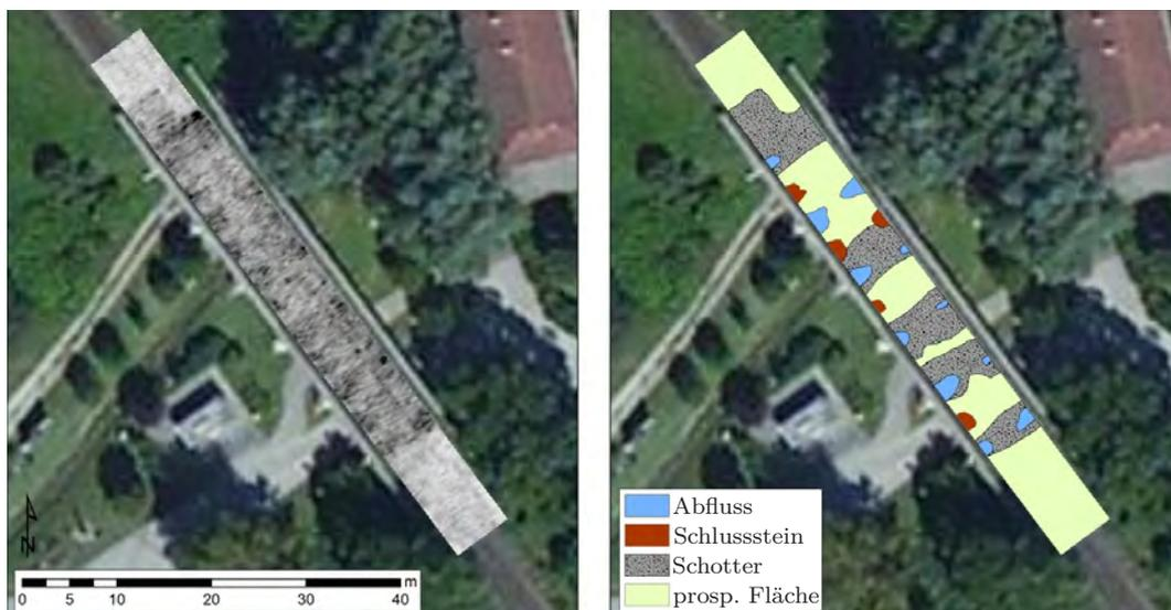
Abbildung 6.19: Darstellung der Draufsicht der Amplitudenfläche (links) und der Interpretation des Tiefenbereiches (rechts) 1.50 bis 2.00 m.
