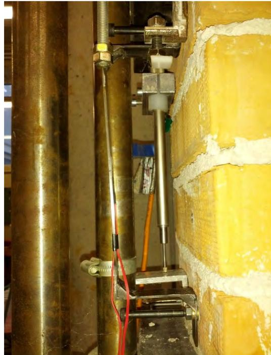
(b) Versuchsaufbau Kalibrierung Messrahmen
