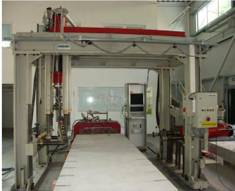
Abbildung 9.13: Servohydraulische Prüfmaschine IKI-02
