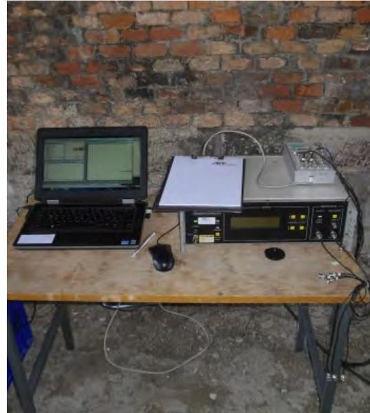
(b) Aufzeichnungsgeräte für die Laservibrometermessung
