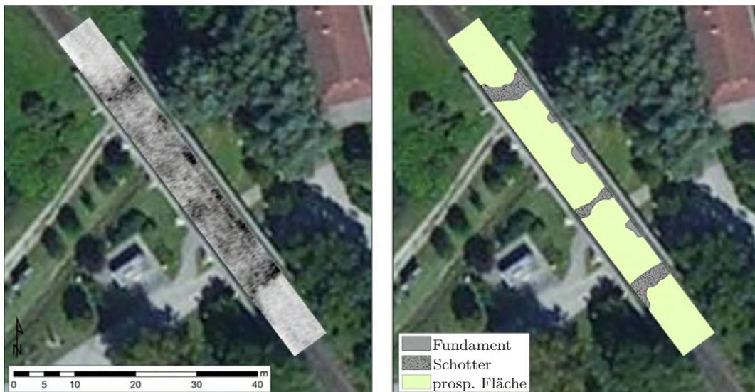
Abbildung 6.21: Darstellung der Draufsicht der Amplitudenfläche (links) und der Interpretation des Tiefenbereiches (rechts) 4.00 bis 4.50 m.
