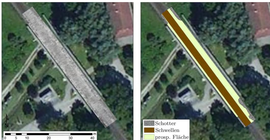
Abbildung 6.16: Darstellung der Draufsicht der Amplitudenfläche (links) und der Interpretation des Tiefenbereiches (rechts) 0.00 bis 0.50 m.
