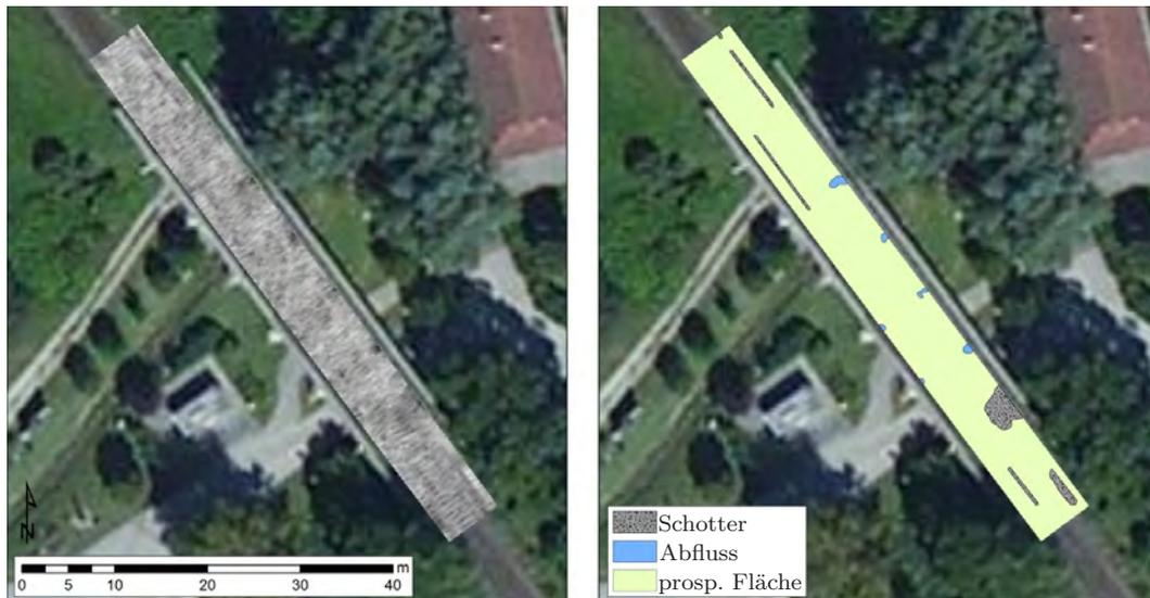
Abbildung 6.17: Darstellung der Draufsicht der Amplitudenfläche (links) und der Interpretation des Tiefenbereiches (rechts) 0.50 bis 1.00 m.
